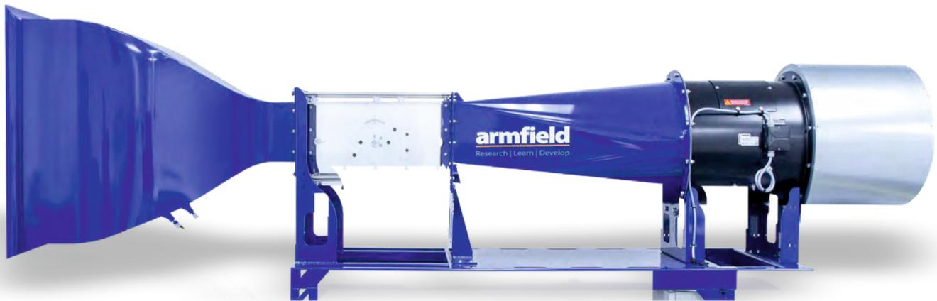
La galleria del vento subsonica Armfield C30 consente all'utente di effettuare studi avanzati nei campi dell'aerodinamica, tra cui esperimenti sullo strato limite, visualizzazione del flusso, distribuzione della pressione, studio della turbolenza e offre la possibilità di sviluppare profili aerodinamici autoprogettati da testare.
