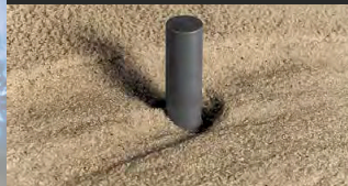
Scorrimento intorno al pilone di un ponte circolare
