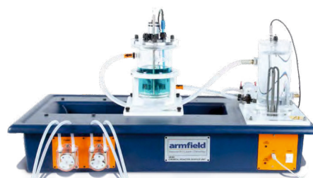
CEB-MKIII montato sull'unità di servizio
