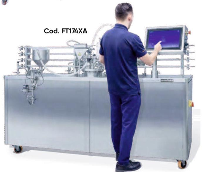
**FT74XA è compatto, mobile e facile da installare. È dotato di un generatore di acqua calda pressurizzato integrato e richiede solo elettricità e acqua di raffreddamento per funzionare, rendendolo ideale per gli spazi ristretti con servizi limitati.**
