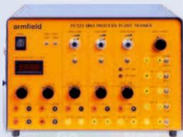
**Il Process Plant Trainer incorpora una console elettrica che permette di accedere ai vari segnali associati alla misurazione e al controllo del processo, consentendo una varietà di possibilità di controllo**
