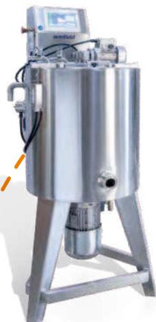
**FT174XA Sistema modulare di processo HTST/ UHT in scala miniaturizzata**
