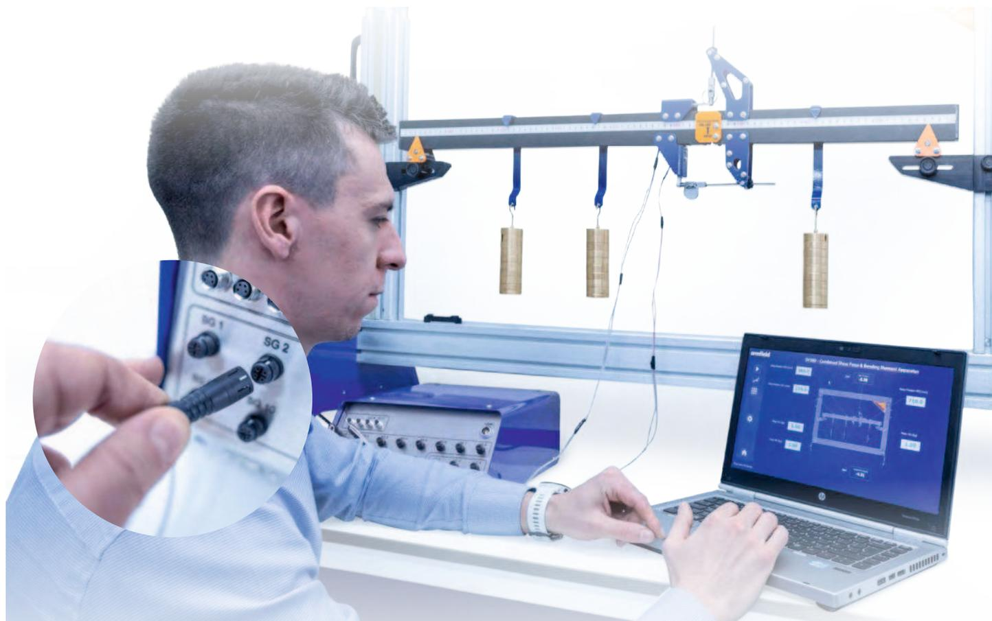
L'Armfield SV101 è un'unità di interfaccia compatta per la gamma Armfield Structures che può essere collocata in una posizione comoda accanto all'apparecchiatura di prova. L'unità fornisce un'integrazione diretta tra un esperimento con strutture compatibili e il software Armfield armBUS. La connessione al computer dell'utente avviene tramite la presa USB montata sul lato anteriore.
