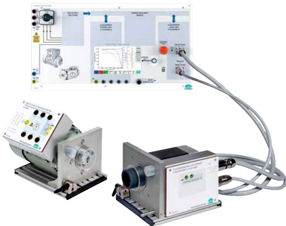
Moderna elettronica di potenza applicata al banco prova motori ETS.
